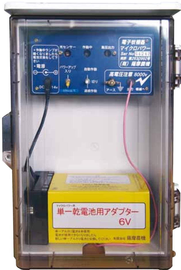
マルチ電源 出力UPスイッチ 自動スイッチ 逆接ブザー 電池切表示 簡易防雨ケース
