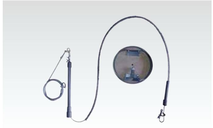
仕掛けたい所に径 250mm、深さ 100mm程の穴を掘り、掘った部分に踏み板セットを入れます。踏み板の塩ビ管はしっかり埋め、不安定にならないようにしてください。薄く土や枯葉を被せて隠せば完成です。
