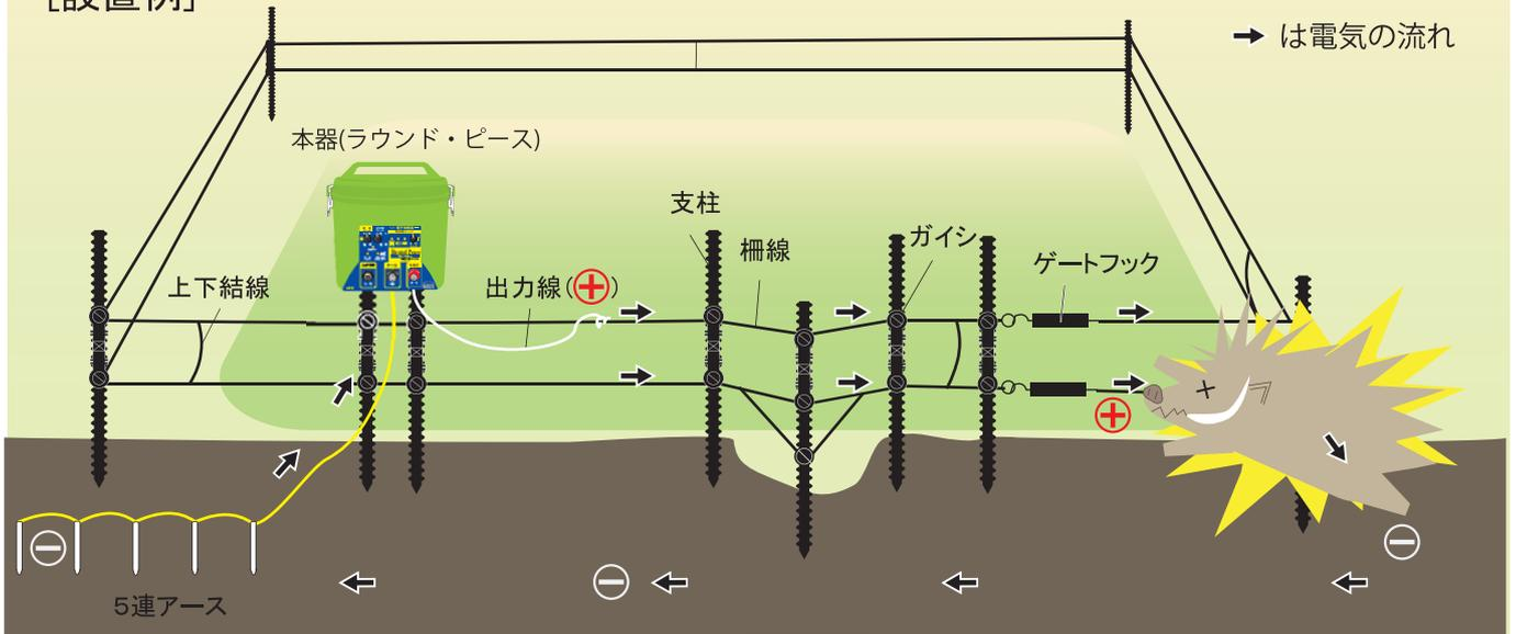
田畑の周囲に電柵線を張り、電柵器の出力端子に出力線、アース端子にアース線をしっかりと接続します。電柵線には一定間隔で衝撃電流が流れ、電柵線とアース（地面）が動物と接触すると「電柵器→電柵線→動物→地面→アース」という閉回路が形成され、動物は強い電気ショックを受けます。アースが無ければ動物は電気ショックを受けません。
